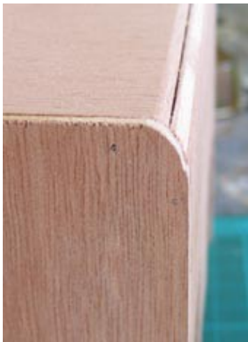
Arrondi réalisé au cutter et au papier de verre dans du contreplaqué (caravane au 1/18 de Micki)
